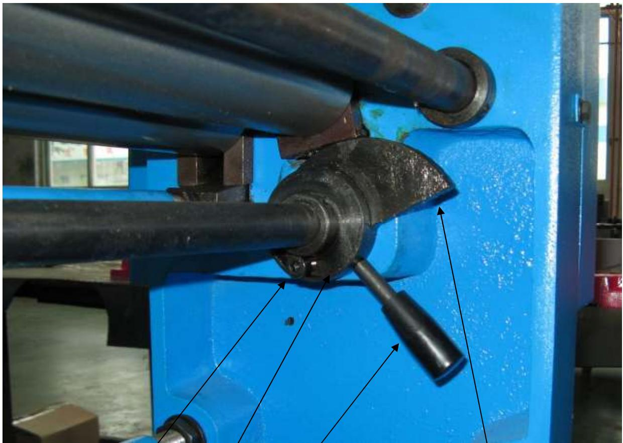
Болт-фиксатор      Муфта      Ручка      Эксцентрик
